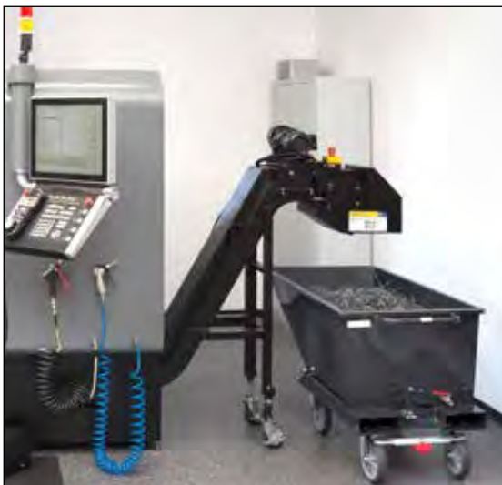
Anwendungsbeispiel: Muldenkipper als Spänebehälter
